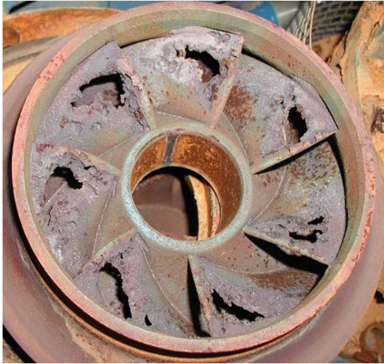
Danni da cavitazione sulle pale di una girante
