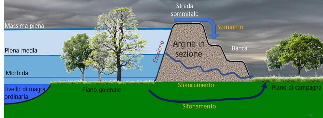
La composizione del corpo dell'argine influisce sulla pendenza della linea piezometrica
