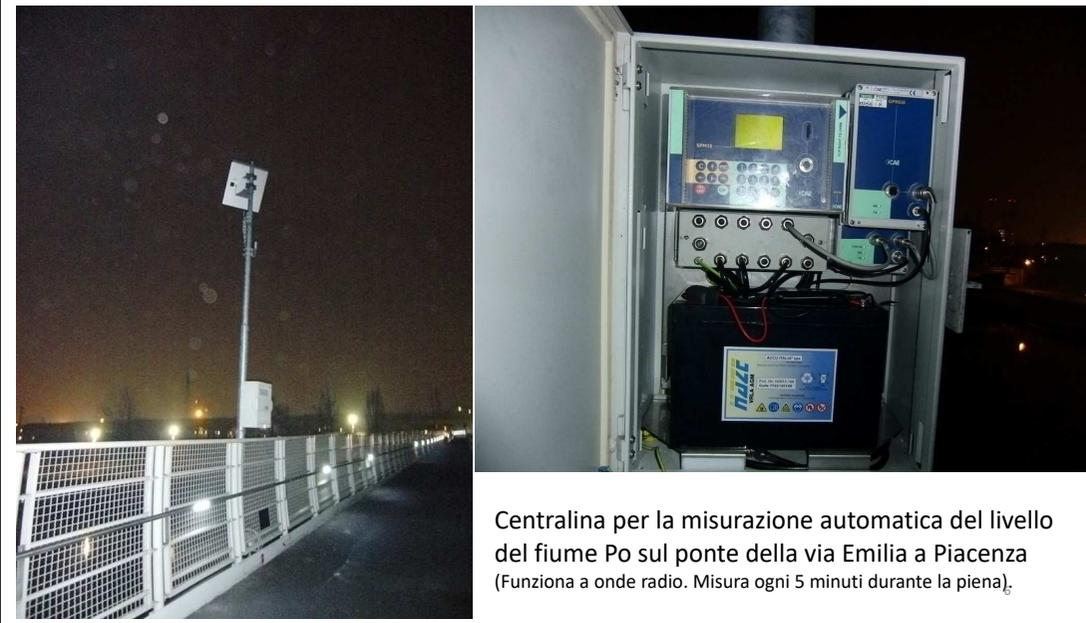
Centralina per la misurazione automatica del livello del fiume Po sul ponte della via Emilia a Piacenza (Funziona a onde radio. Misura ogni 5 minuti durante la piena).
