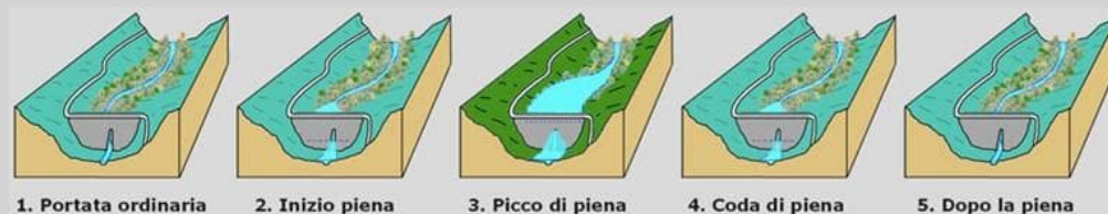
Fig. 30. Schema di funzionamento degli invasi montani di laminazione (sbarramenti a bocca tarata). Lo scopo è trattenere temporaneamente nell'invaso le portate eccedenti una certa soglia (quelle che produrrebbero esondazione a Carrara), rilasciandole in seguito, quando il picco di piena è già passato e le acque possono transitare a valle senza provocare danni. 1: lo sbarramento ha un'apertura sul fondo (qui disegnata verticale, ma solitamente orizzontale) che lascia passare interamente le portate ordinarie. 2: all'arrivo di una piena non tutta l'acqua riesce a passare dalla bocca tarata, perciò il livello nell'invaso inizia ad aumentare. 3: col picco di piena si raggiunge il massimo livello nell'invaso. 4: passato il picco di piena, l'acqua invasata continua a uscire e il livello nell'invaso cala. 5: nel giro di qualche ora (per il Carrione) l'invaso è nuovamente vuoto. Non si tratta quindi di laghi, ma di bacini completamente vuoti per diversi anni, salvo attivarsi per qualche ora in occasione di piene superiori a una certa soglia.
